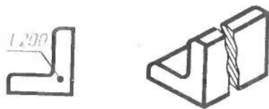
Рис. 33. Нанесение размера длины детали
