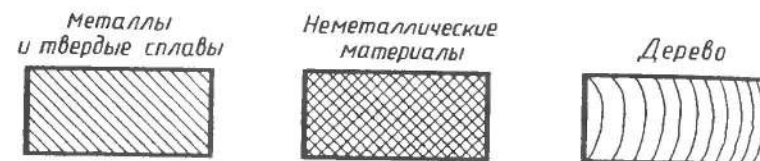
Рис. 198. Некоторые графические обозначения материалов
