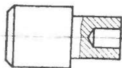
Рис. 189. Построение местного разреза
