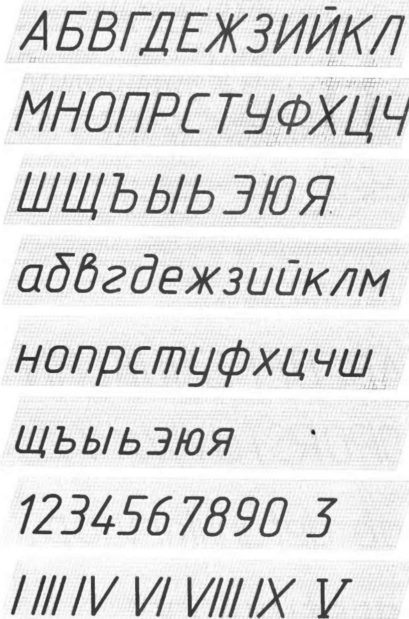
Рис. 25. Буквы и цифры чертежного шрифта
